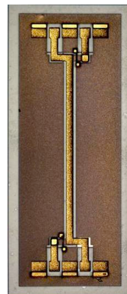
Figure 35 : Coupleur 90° de type broadside (couplage par la face) [40]
