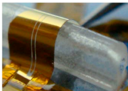
Figure 98. Capteur HF flexible placé autour d'un tube fluidique en plastique
