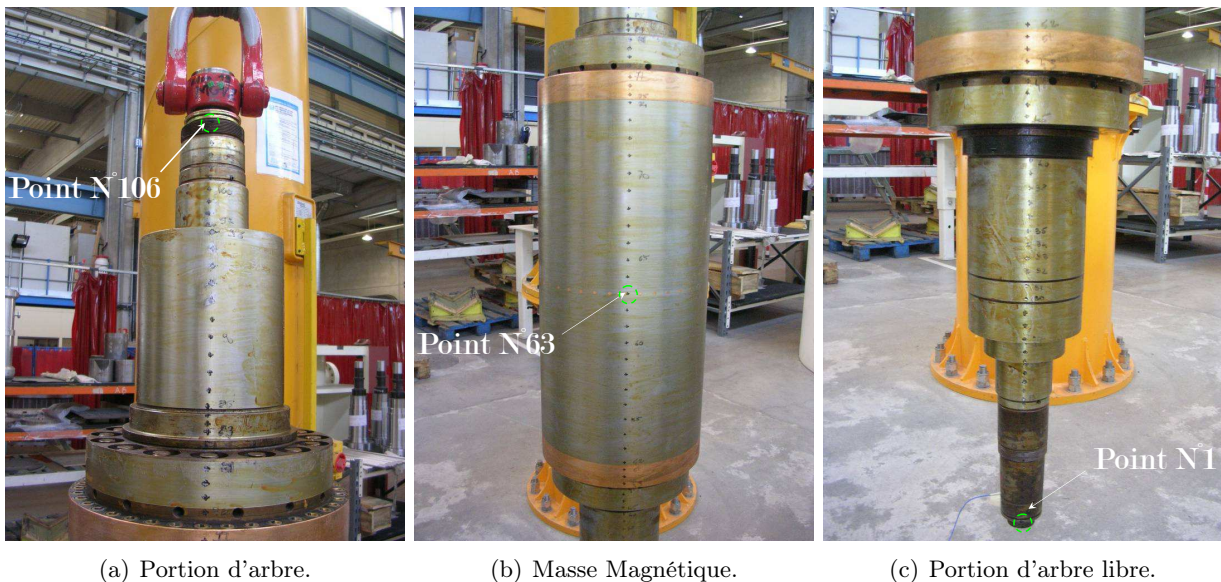
FIGURE 3.9 – Dispositif de suspension et maillage expérimental.
