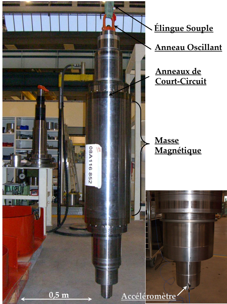
FIGURE 4.15 – Dispositif expérimental employé lors de l'analyse modale.
