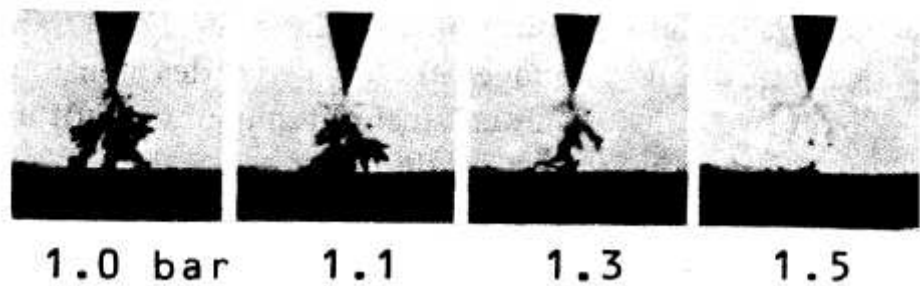
Figure 2.5 : Streamer négatif dans le cyclohexane sous l'influence de la pression [51].
