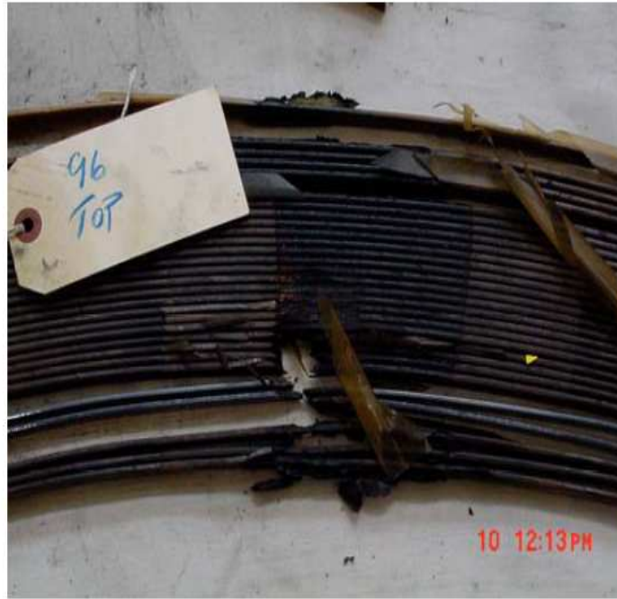
Figure VI.3 : Claquage entre les brins du conducteur sur un disque en carton ou entre les disques [90].
