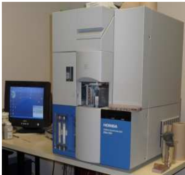
Figure VI.5 : EMIA-220V de HORIBA. Détecteur de soufre et de carbone.
