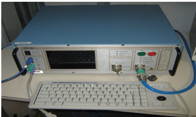
Figure II.10 : Système de diagnostic d'isolation IDA 200 TM pour la mesure du facteur de dissipation et de la conductivité.
