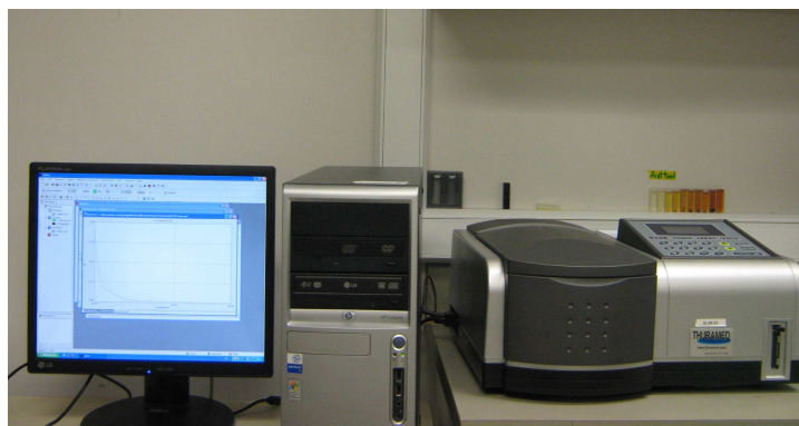
Figure II.1: Spectrophotomètre T60 UV/Visible permettant la mesure des produits de décomposition dissous.
