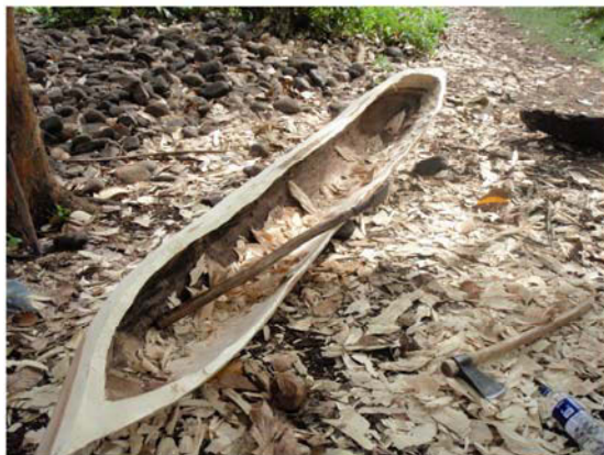
c) Pirogue en construction (15 jours de travail)
