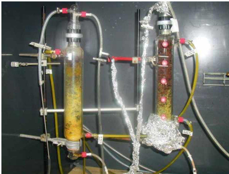
Photographie 13. Bioréacteurs utilisés pour étudier la précipitation du sulfure d'arsenic par l'hydrogène sulfuré produit par des BSR
