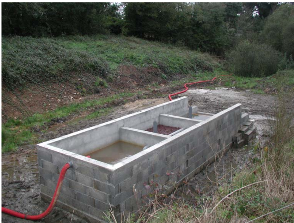
Photographie 8. Pilote de traitement biologique passif installé sur le site de Lopérec
