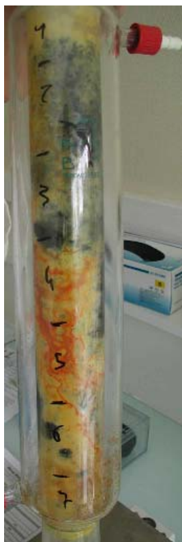
Photographie 15. Répartition des zones de précipitation du sulfure d'arsenic (jaune-orangé) et de production d' H_2S (noires) au démontage du bioréacteur, après 582 jours de fonctionnement.
