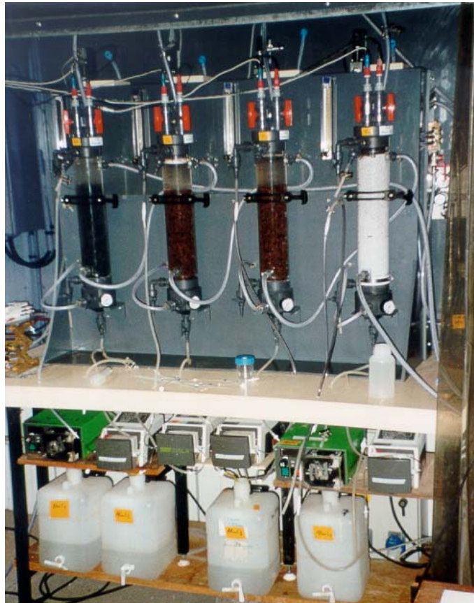
Photographie 9. Bioréacteurs à lit fixe inoculés avec D. norvegicum Hildenborough et alimentés avec un mélange \text{H}_2/\text{CO}_2 pour le traitement en continu des eaux polluées par du Cr(VI). Comparaison de différents types de remplissages.
