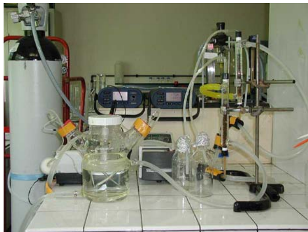
Photographie 6. Expérience en continu (colonnes de 20 ml) ayant permis de mettre en évidence l'oxydation bactérienne de l'As(III) dans des conditions très proches de celles du site de Lopérec.
