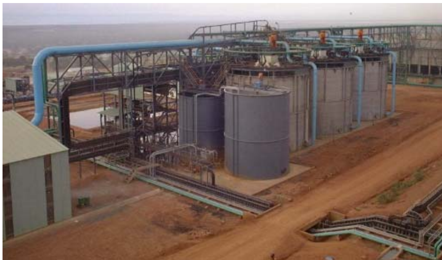
Photographie 2. Bioréacteurs de 1350 m 3 permettant d'extraire du cobalt à partir de la pyrite de Kasese (Ouganda) fonctionnant depuis 1999 sur la base du procédé mis au point au BRGM
