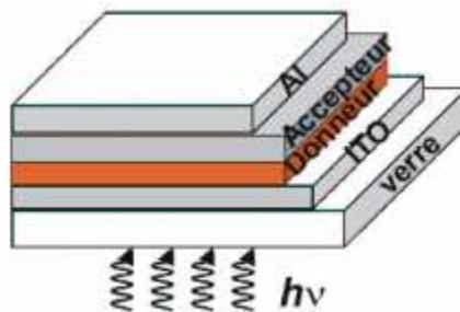
**Figure 12 : Schéma d'une cellule solaire organique basé sur une bicouche donneur-accepteur. L'épaisseur totale de la cellule doit être un bon compromis entre l'absorption du spectre solaire et la longueur de diffusion des excitons.**
