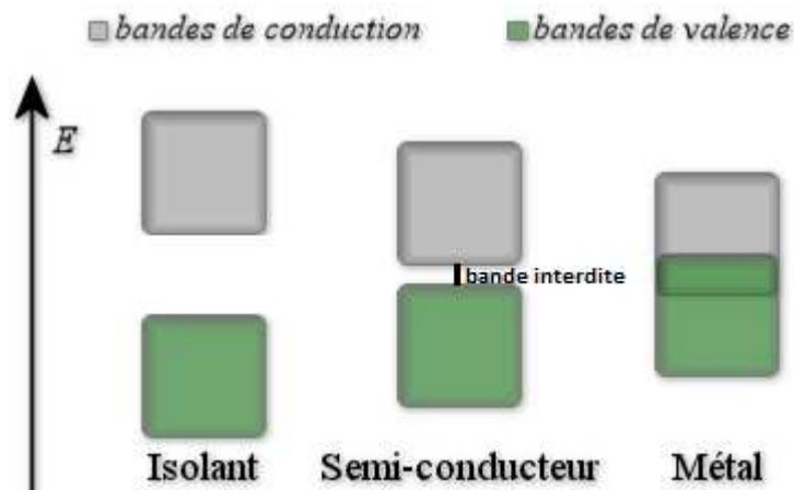
*Figure 11 : Diagramme de bandes d'un isolant, d'un semi-conducteur et d'un métal. Pour être promu dans la bande de valence, un électron doit absorber au moins autant d'énergie lumineuse que l'énergie de la bande interdite.*
