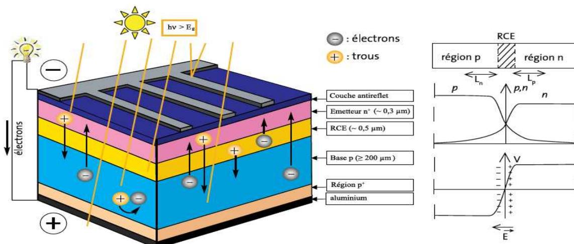
**Figure 10 : Schéma d'une cellule solaire inorganique (à gauche). Variation des concentrations en porteurs de charges (p et n) et du potentiel électrostatique (V) à travers une jonction p-n non polarisée (à droite)<sup>10</sup>.**
