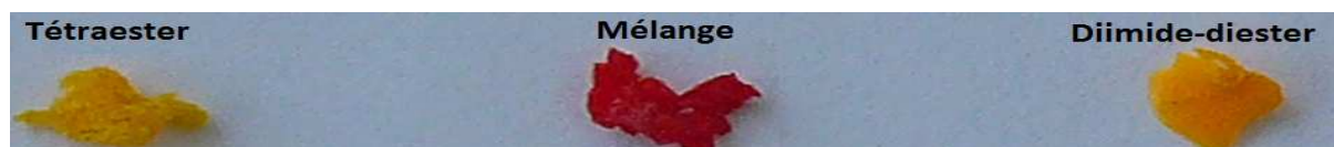
Figure 51 : Obtention d'un effet bathochrome dans un mélange donneur/accepteur.
