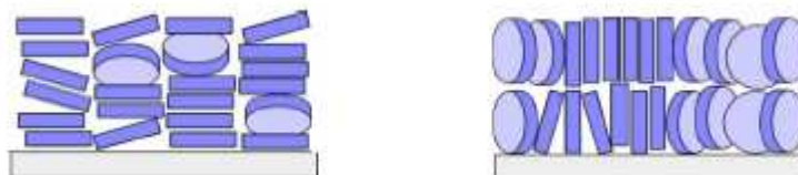
Figure 9 : Alignement homéotrope (gauche) et planaire (droite).
