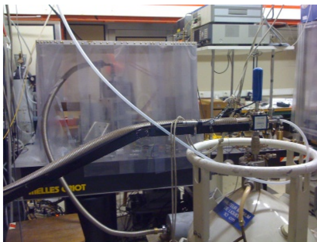
FIGURE 1.13 – Vue du sas en plastique transparent (au deuxième plan sur la photo) qui permet d'amortir les fluctuations de la température.
