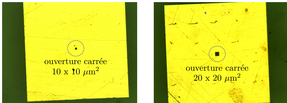
FIGURE 2.16 – Diaphragmes d'alignement déposés sur la surface de l'échantillon. Images prises au microscope optique. Des rayures sont dues aux nettoyages successifs de la surface.
