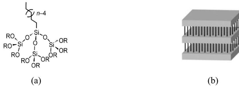
Figure III. 2 : (a) Exemple de précurseur d'alkyltrialkoxysilane pour la synthèse de films mésoporeux lamellaires ou hexagonale 2D ( $n = 14 - 18$ ) ; (b) structure lamellaire de silice intercalée de phase organique (groupements alkyles) (d'après [23]).
