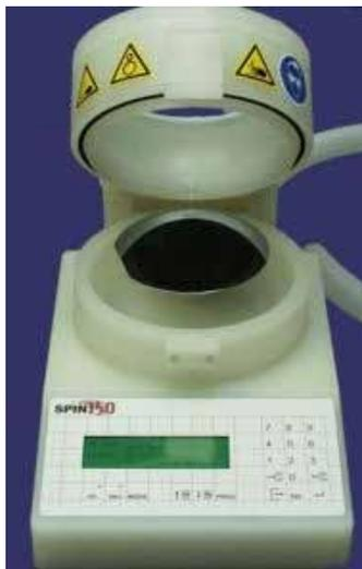
Figure IV. 3 : Photographie du spin coater SPS 150.
