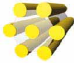
Figure III.3 : représentation schématique de la mésostructure hexagonale 2D (groupe d'espace P6mm ) (les cylindres représentent des mésopores) (d'après [28]).
