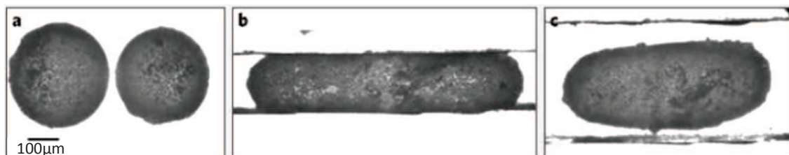
Figure 21 : (a) : Bulles stabilisées par des particules de polystyrène (2.6 \mu\text{m} ), (b) : compression des bulles entre deux plaques de verre, ce qui provoque la coalescence, (c) : la forme anisotrope persiste après le retrait des barrières mobiles (Subramaniam, et al., 2005).
