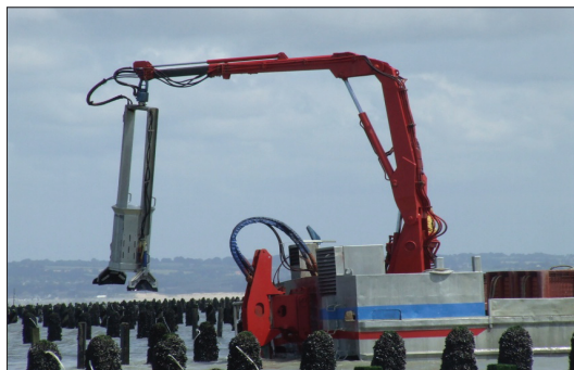
Fig. 17 : Grue hydraulique et pêcheuse, à l'arrière d'un bateau amphibie (2008)
