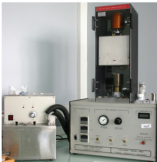
(a) Conductivimètre Unitherm 2021
