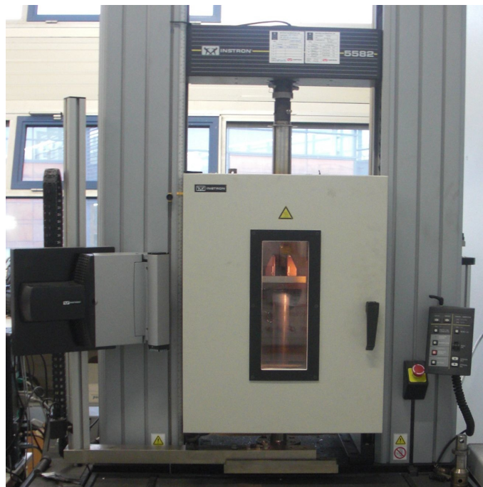
FIGURE IV.5 – Dynamomètre INSTRON 5585 avec enceinte thermique
