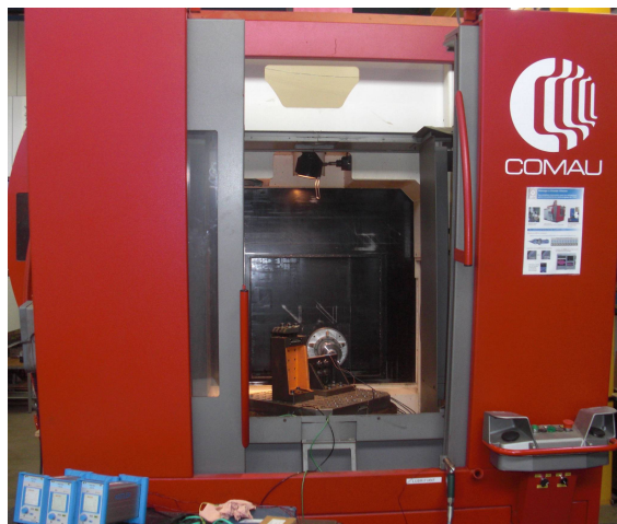
FIGURE II.1 – Machine d'usinage grande vitesse Siemens MT01
