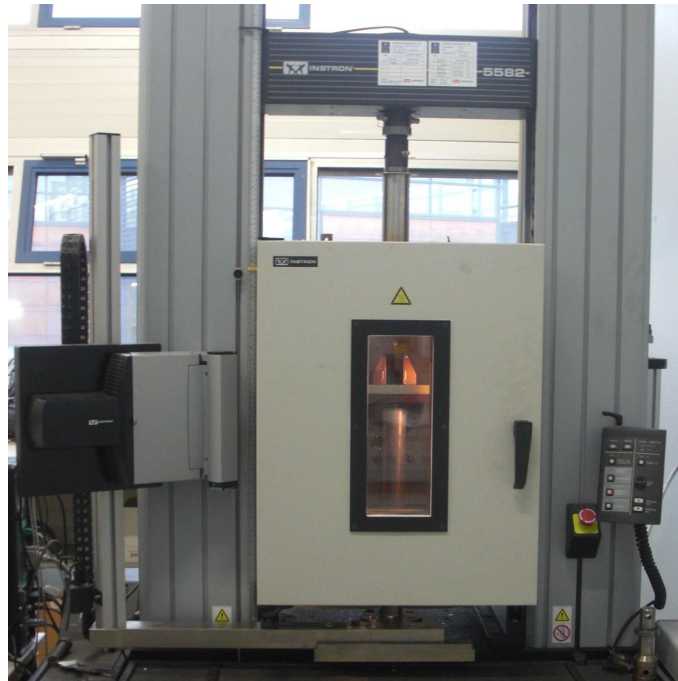
FIGURE IV.5 – Dynamomètre INSTRON 5585 avec enceinte thermique
