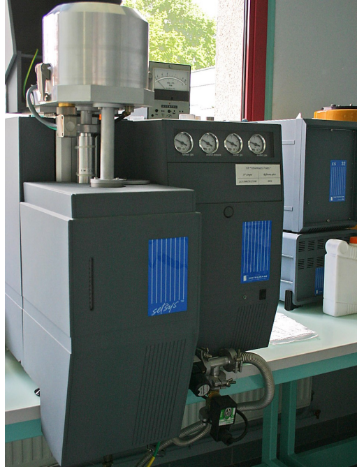
FIGURE A.3 – Mesure de capacité thermique : calorimètre Setaram C80
