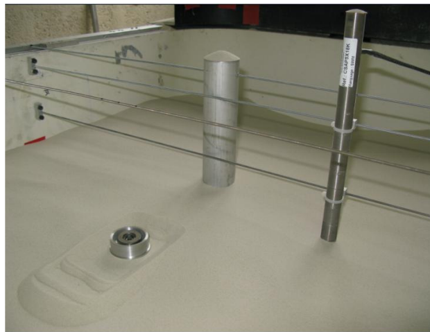
Figure VI-11. Mise en place des semelles enterrées lors de la pluviation
