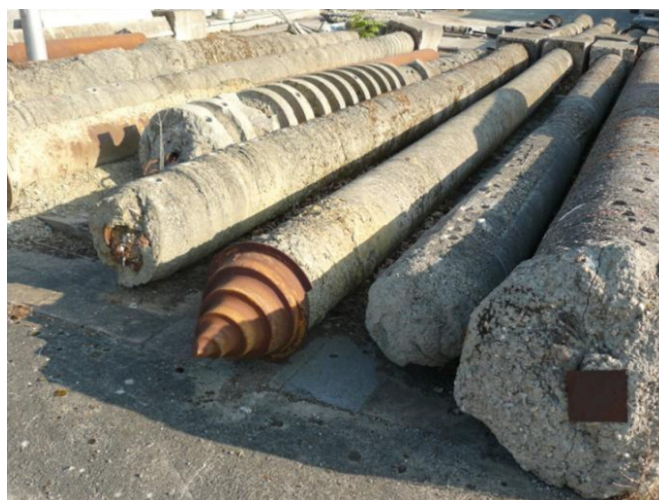
Figure VII-14. Quelques pieux vissés dans le site de Limelette après leur excavation
