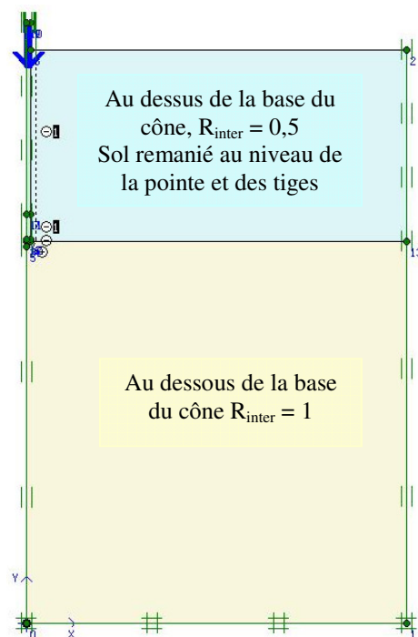
Figure IV-5. Variation de R_{inter} au dessus et au dessous de la base du cône
