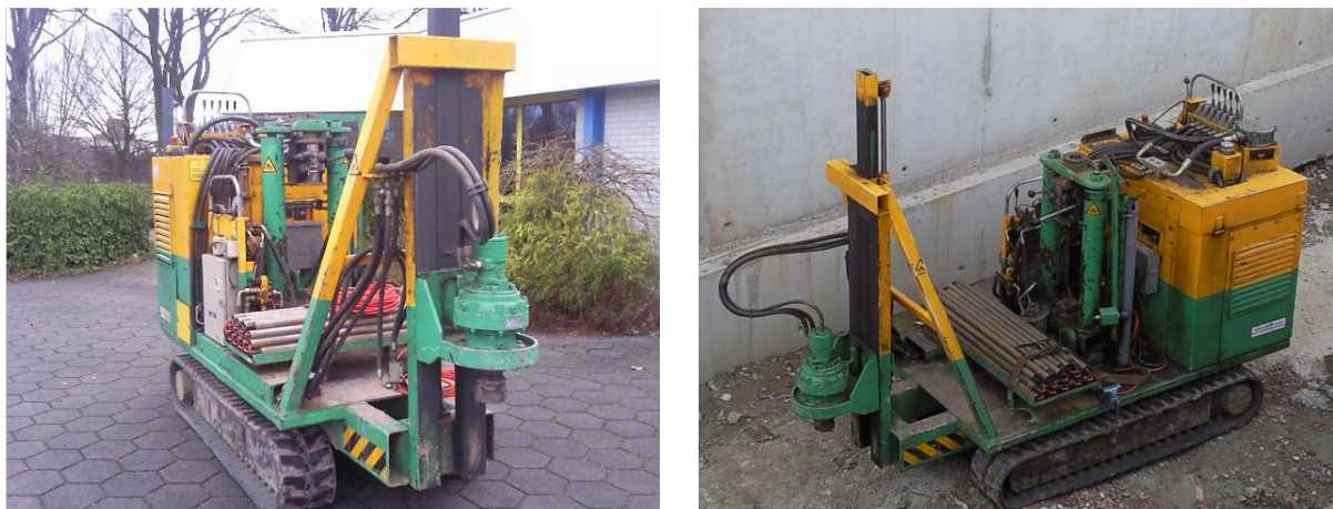
Figure III-2. Mini – chenillard sur lequel le pénétromètre est installé
