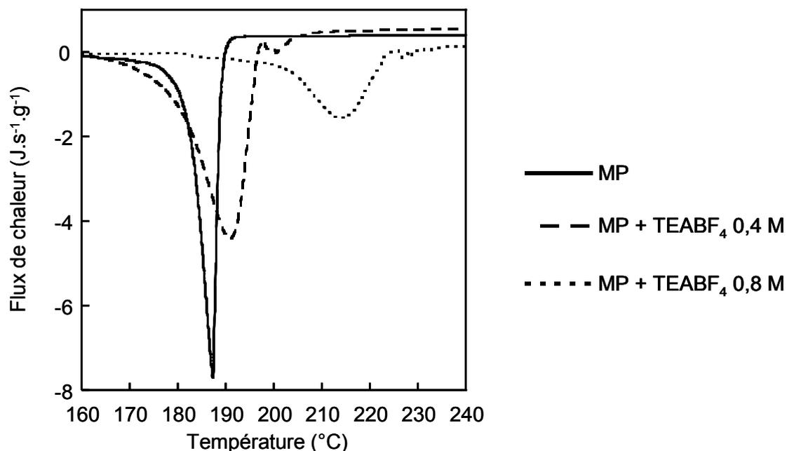
Figure 61 : Courbes de DSC du MP avec et sans TEABF<sub>4</sub>
