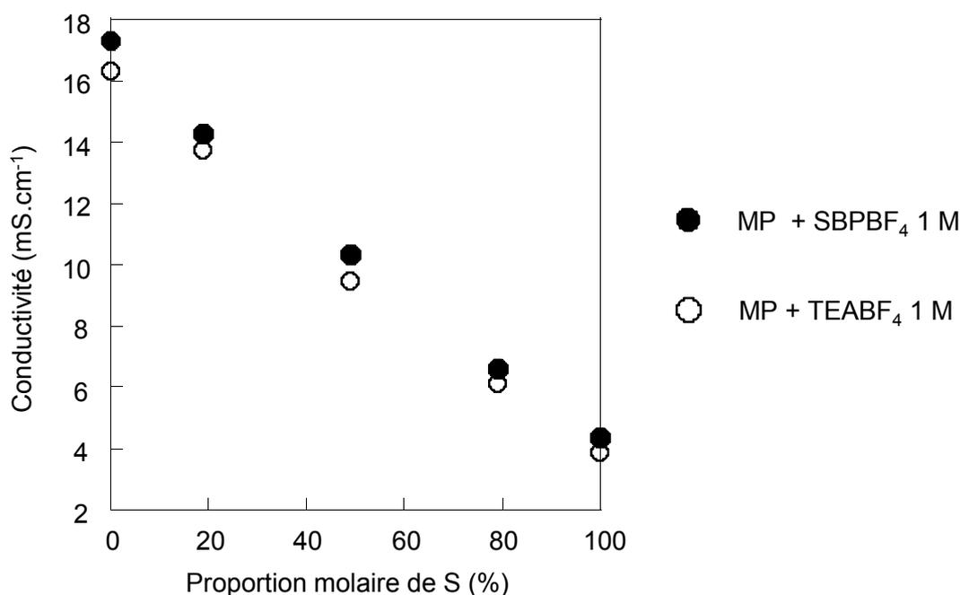
**Figure 54 : Conductivité à 30°C des électrolytes à base de mélanges de S et du co-solvant MP et de SBPBF<sub>4</sub> ou TEABF<sub>4</sub> 1 M**
