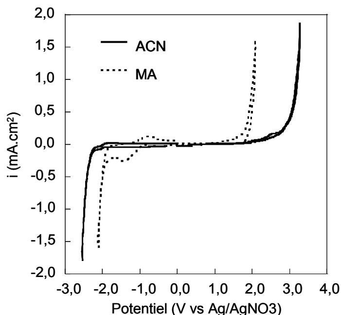
Figure 31 : Voltampérogrammes de MA + TEABF<sub>4</sub> 1 M et de l'ACN + TEABF<sub>4</sub> 1 M
