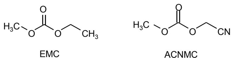
Figure 22 : Schéma des molécules d'EMC et d'ACNMC
