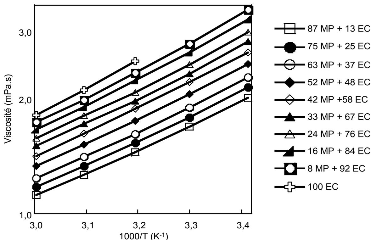
Figure 74 : Viscosité des mélanges MP + EC + TEABF<sub>4</sub> 1 M en fonction de la température
