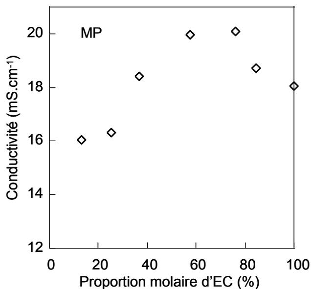
**Figure 40 : Conductivité à 30°C des électrolytes à base de mélange d'EC et du co-solvant : MP et TEABF<sub>4</sub> 1M**
