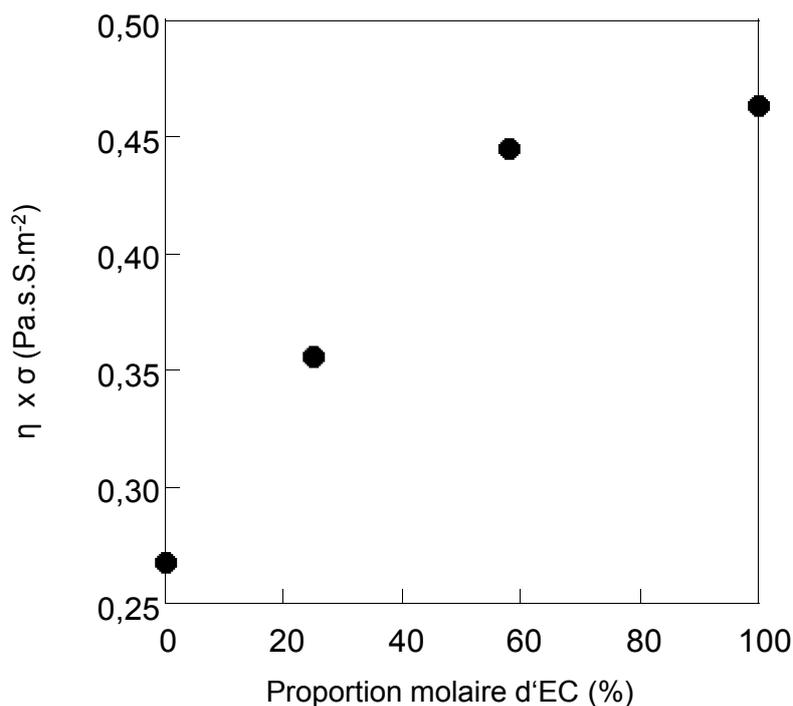
Figure 88 : Produit de Walden des mélanges MP / EC + SBPBF<sub>4</sub> à 40°C
