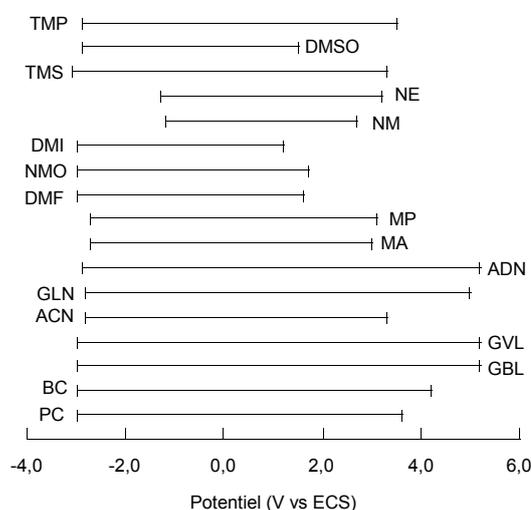
**Figure 10 : Caractéristiques physicochimiques des solvants et électrolytes associés : constante diélectrique  $\epsilon_r$ , viscosité  $\eta$  à 25°C, conductivité ionique à 25°C (avec TEABF<sub>4</sub> 0,65 M) et domaine de stabilité électrochimique mesuré sur carbone vitreux selon [43]**
