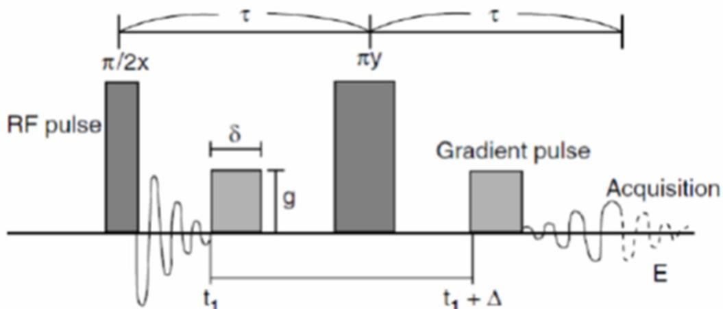
**Figure 100 : Illustration d'une séquence d'impulsions pour la mesure du coefficient de diffusion selon [135]**
