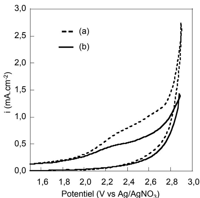
**Figure 15 : Voltampérogrammes (sur platine, vitesse de balayage 100 mV.s<sup>-1</sup>) contrôlant l'état de purification du sel : a) l'électrolyte brut, (b) l'électrolyte dont le sel a été purifié**
