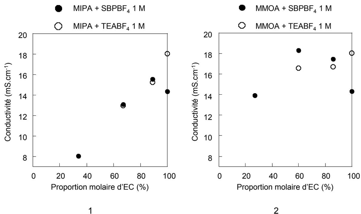
**Figure 51 : Conductivité à 30°C des électrolytes à base de mélange d'EC et des co-solvants MIPA (1) ou MMOA (2) et de SBPBF<sub>4</sub> 1 M ou de TEABF<sub>4</sub> 1 M**
