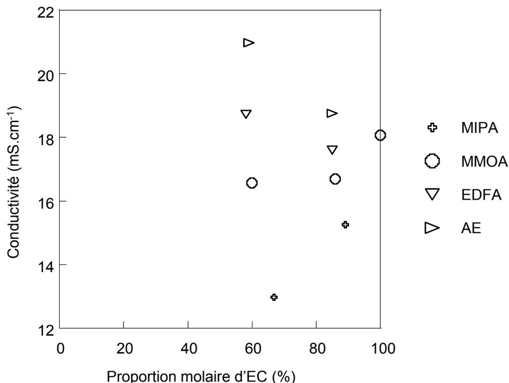
**Figure 41 : Conductivité à 30°C des électrolytes à base de mélange d'EC et de co-solvants : MIPA, MMOA, AE et EDFA avec TEABF<sub>4</sub> 1 M**
