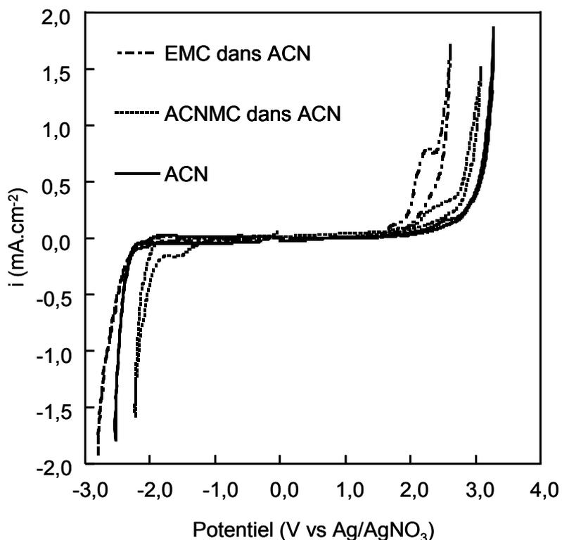
Figure 23 : Voltampérogrammes d'EMC dans ACN + TEABF<sub>4</sub> 1 M et d'ACNMC dans ACN + TEABF<sub>4</sub> 1 M
