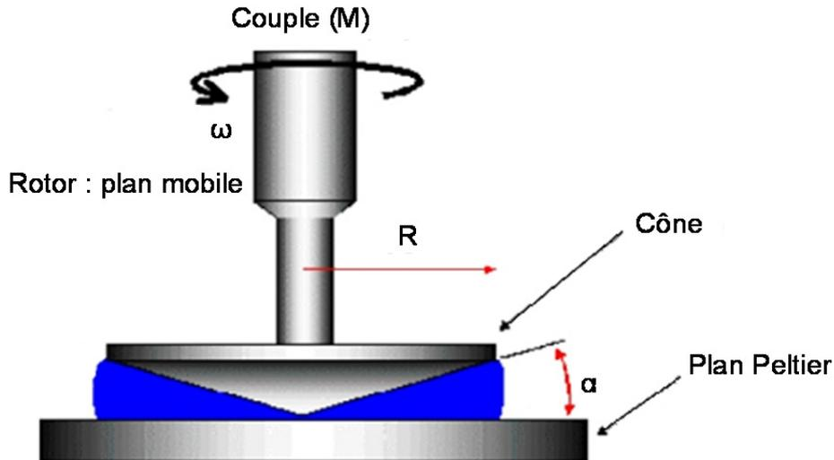
Figure 103 : Schéma du rhéomètre cône-plan utilisé
