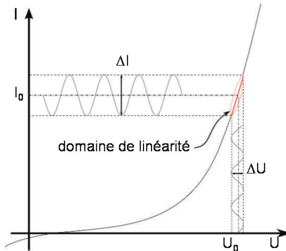
Figure 92 : Réponse d'un système non linéaire soumis à une tension sinusoïdale
