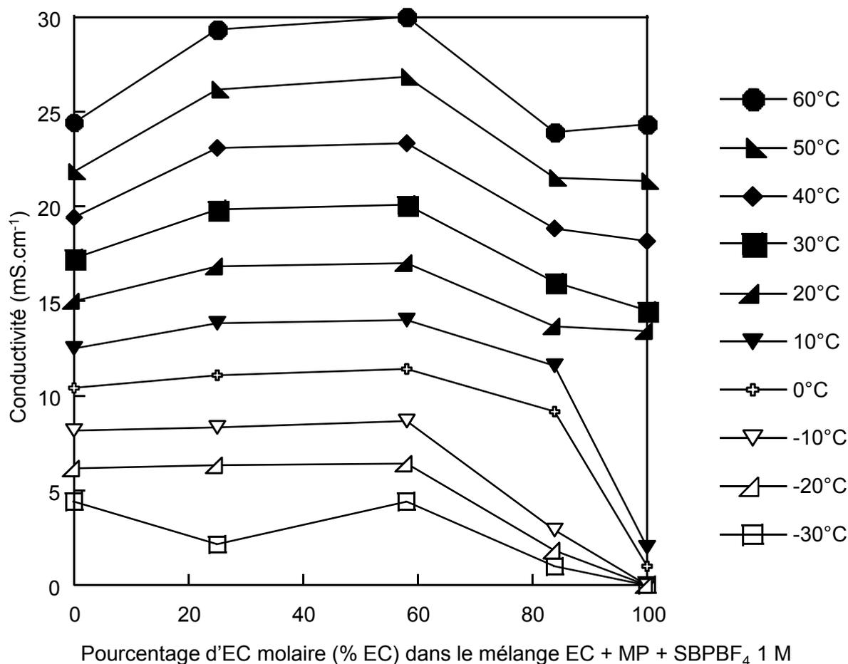
**Figure 85 : Evolution de la conductivité des mélanges MP + EC + SBPBF<sub>4</sub> 1 M en fonction de la proportion molaire d'EC pour différentes températures**
