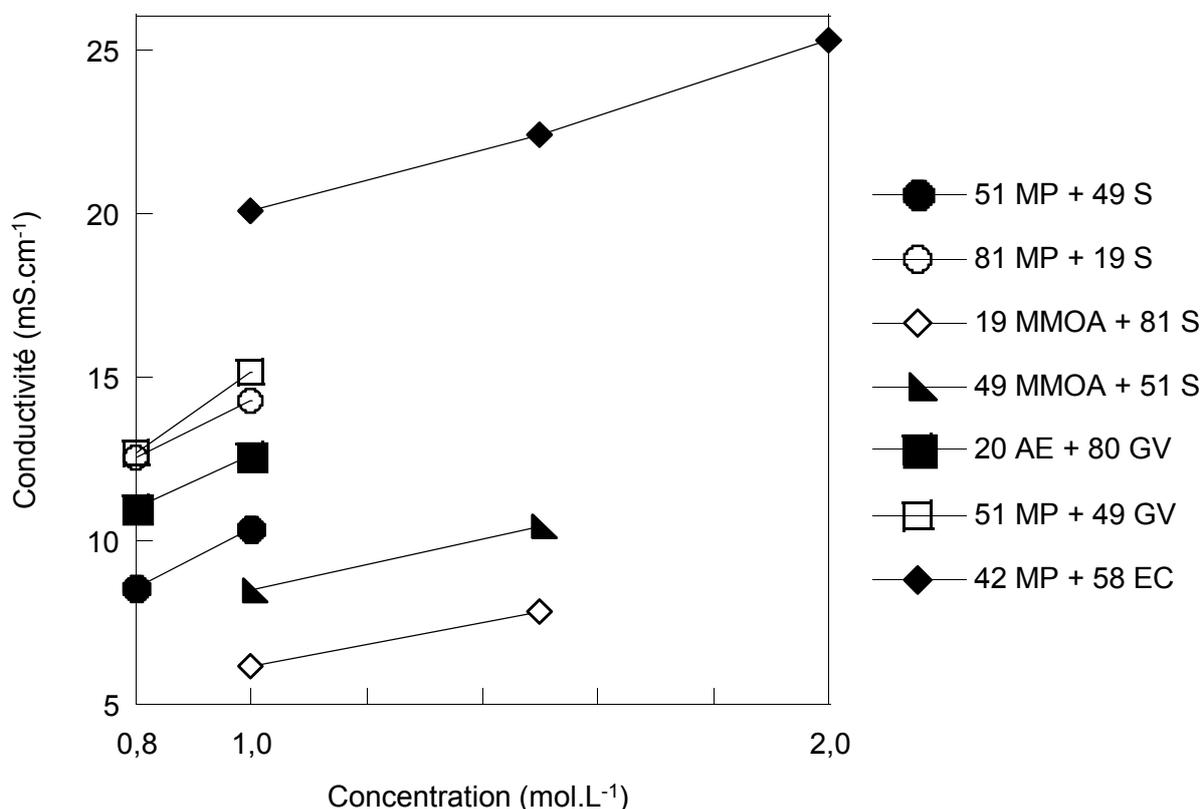
Figure 58 : Conductivité à 30°C des électrolytes à base de mélange de solvants (proportion molaire) en fonction de la concentration molaire en SBPBF<sub>4</sub>
