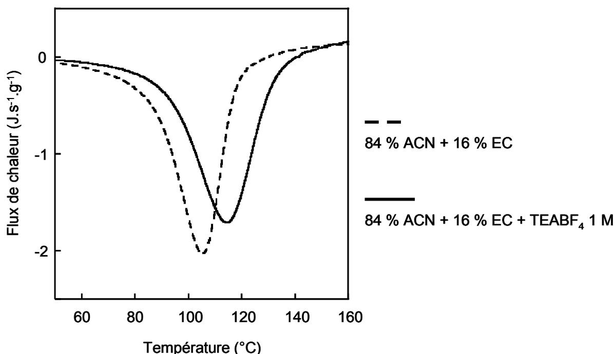
Figure 68 : Courbes DSC du mélange ACN + 16 % EC avec et sans TEABF<sub>4</sub>
