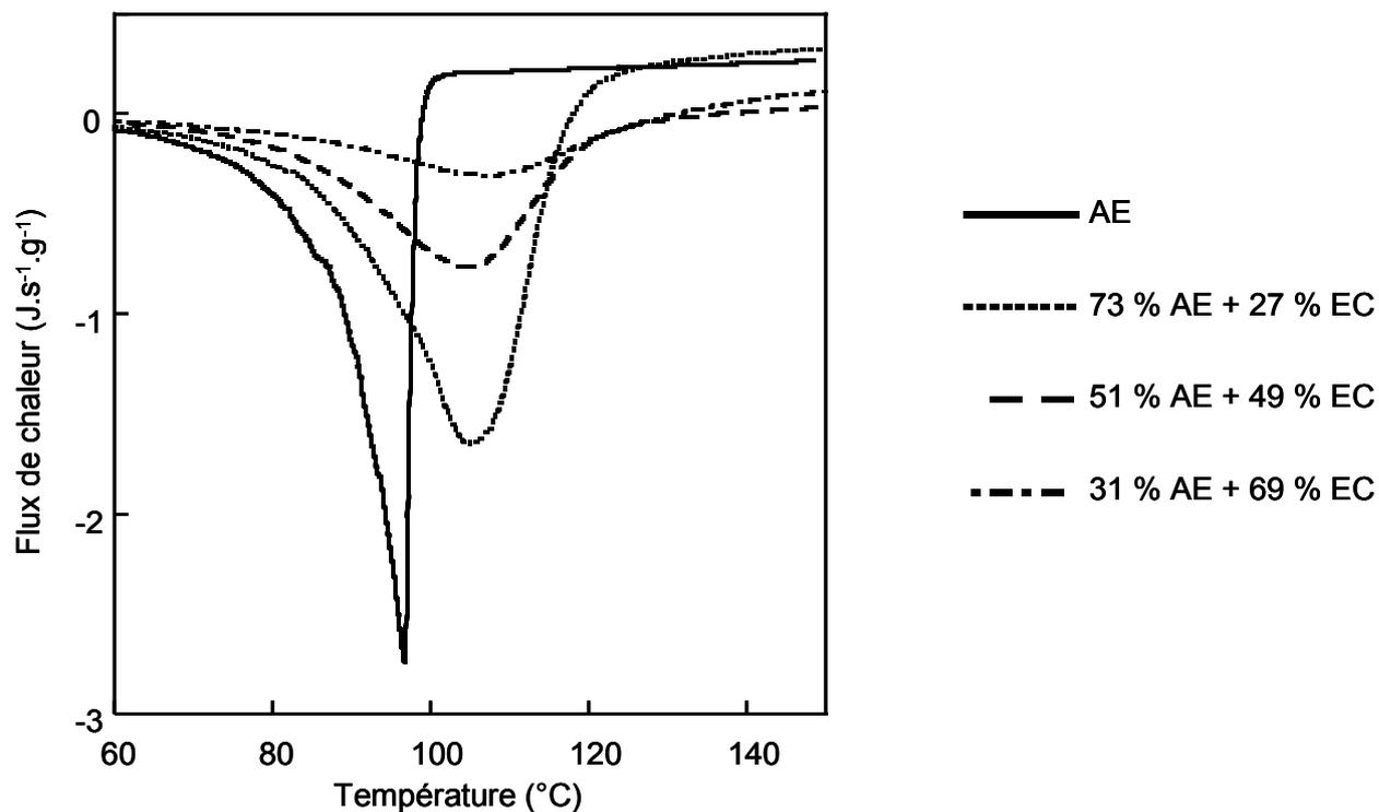
Figure 63 : Courbes DSC de l'AE avec différentes proportions molaires en EC
