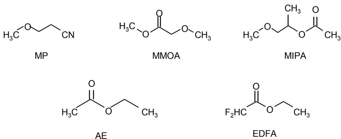
Figure 39 : Schéma des molécules des co-solvants sélectionnés
