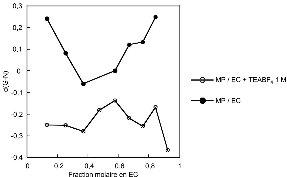
Figure 78 : d(G-N) en fonction de la fraction molaire en EC, pour les mélanges MP / EC + TEABF<sub>4</sub> 1 M et les mélanges MP / EC à 40°C
