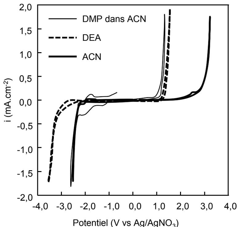
**Figure 18 : Voltampérogrammes du DEA dans ACN + TEABF<sub>4</sub> 1 M, de l'ACN + TEABF<sub>4</sub> 1 M et du DMP + TEABF<sub>4</sub> 1 M**
