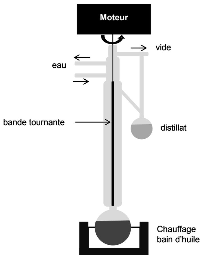
Figure 89 : Schéma d'une distillation à bande tournante
