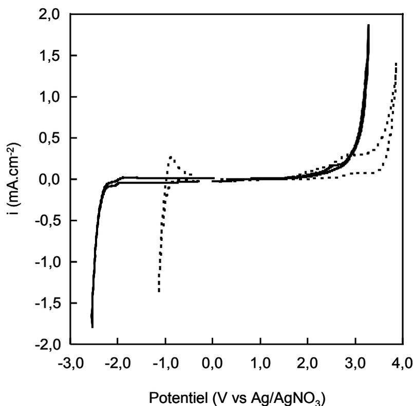
Figure 25 : Voltampérogrammes du MCA + TEABF<sub>4</sub> 1 M et d'ACN + TEABF<sub>4</sub> 1 M
