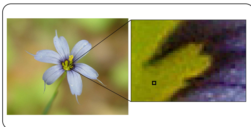
FIG. 1.14 – Représentation d'un pixel pour une image matricielle.
