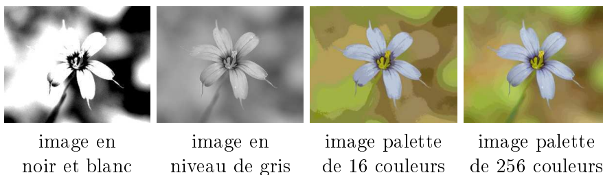
FIG. 1.15 – Représentation de différentes images utilisant une palette.
