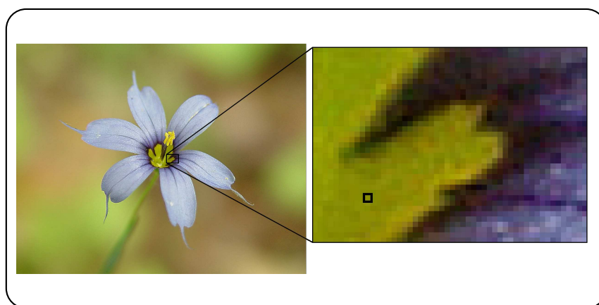
FIG. 1.14 – Représentation d'un pixel pour une image matricielle.
