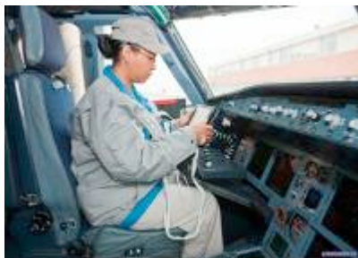
Figure 76 - Appareil mobile attaché à une veste et accroché/attaché à l'aide d'une pieuvre
