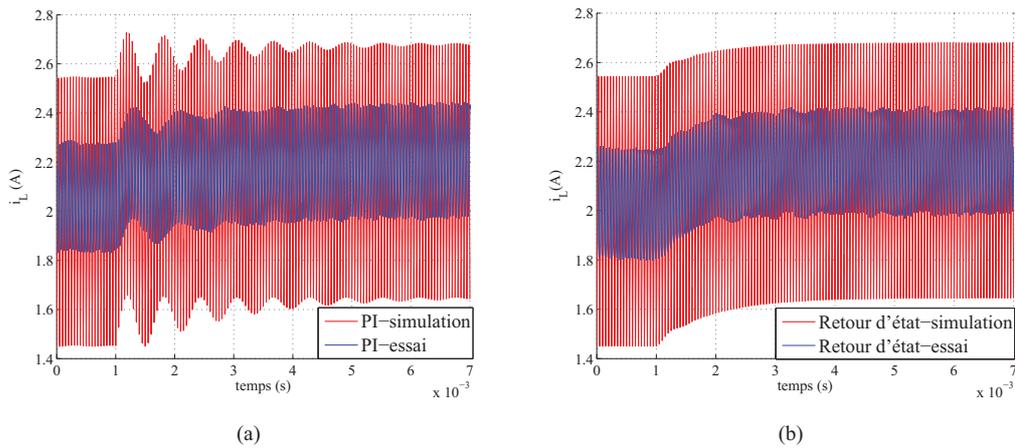
FIGURE 5.6: Evolutions temporelles du courant traversant l'inductance.
