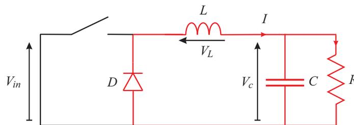
FIGURE 5.3: Interrupteur bloqué.
