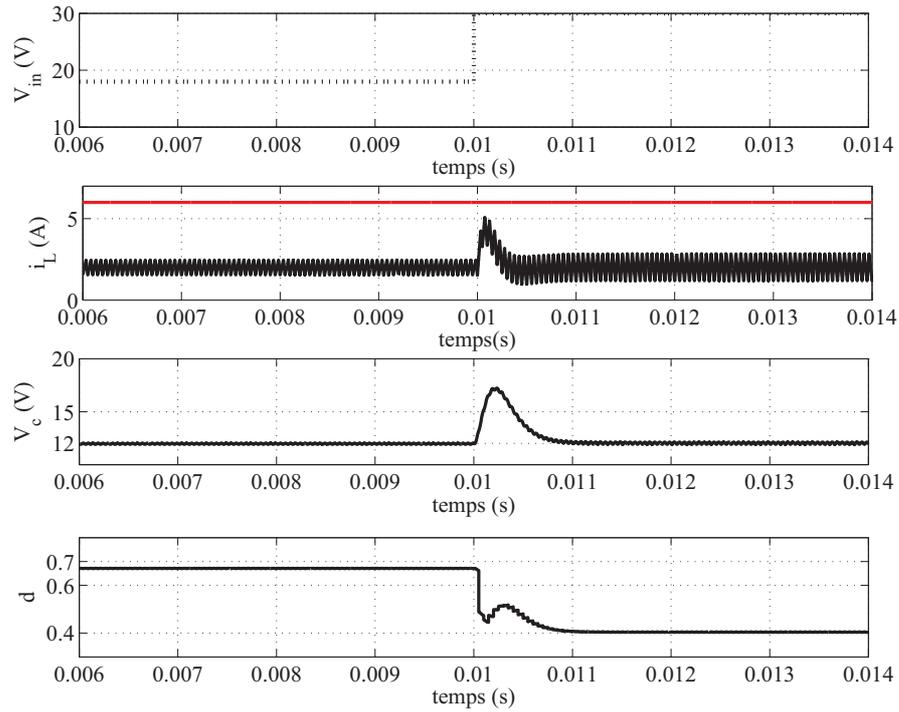
FIGURE 5.11 : Evolutions temporelles du courant traversant l'inductance, de la tension de sortie et du rapport cyclique ( $r = 0,8$ ).
