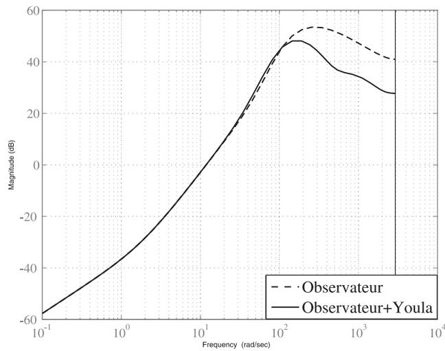
FIGURE 3.2: Fonction de sensibilité vis-à-vis d'une incertitude additive.
