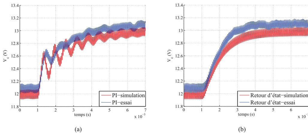
FIGURE 5.7: Evolutions temporelles de la tension de sortie.
