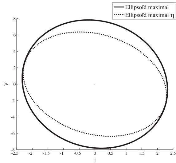
FIGURE 5.26: Projection sur  $\tilde{V}$  et  $\tilde{I}$  des ellipsoïdes invariants maximaux.
