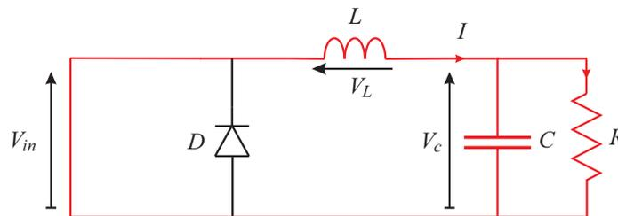
FIGURE 5.2: Interrupteur passant.
