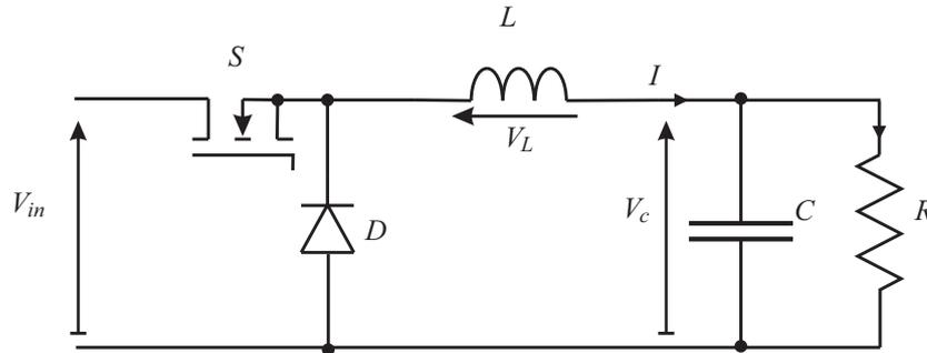
FIGURE 5.1: Schéma de base d'un convertisseur Buck.
