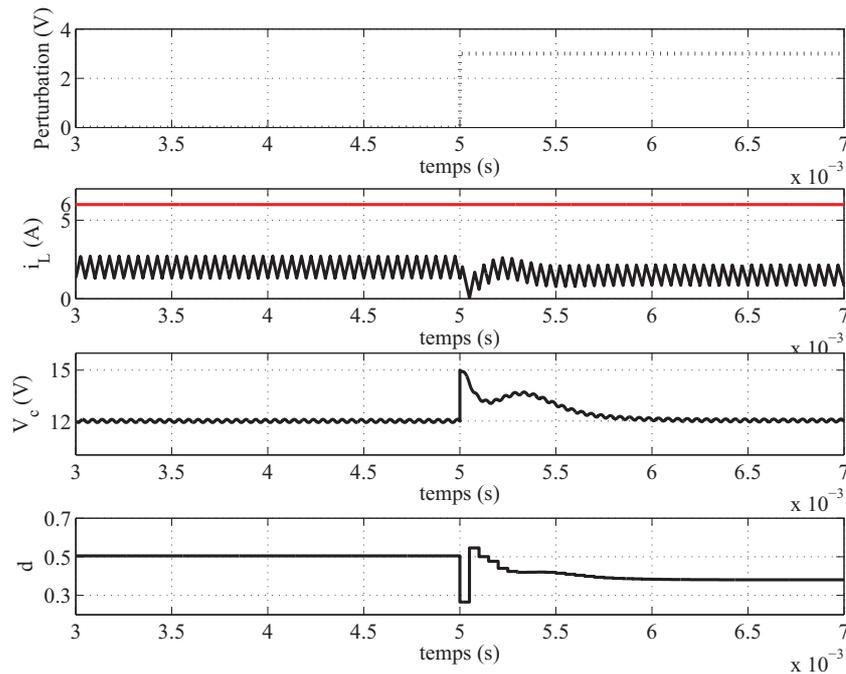
FIGURE 5.23: Evolutions temporelles du courant traversant l'inductance, de la tension de sortie et du rapport cyclique (avec perturbation sur la sortie).
