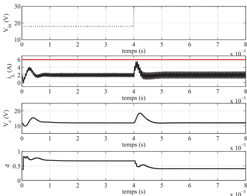
FIGURE 5.22: Evolutions temporelles du courant traversant l'inductance, de la tension de sortie et du rapport cyclique.
