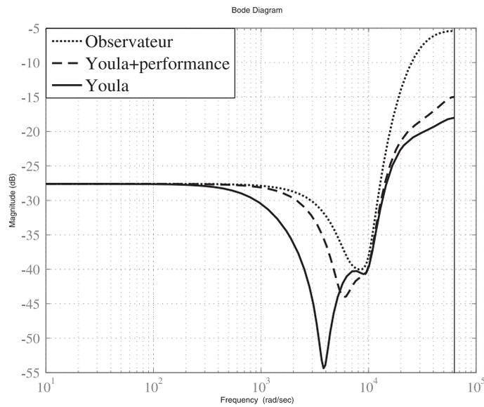
FIGURE 5.20: Fonction de sensibilité vis-à-vis d'une incertitude additive.
