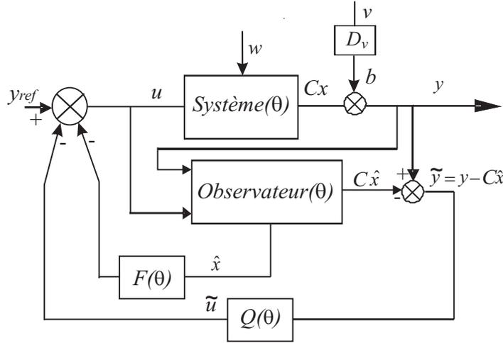
FIGURE 3.7: Correcteur dans l'espace d'état avec paramétrisation de Youla à paramètre variant.
