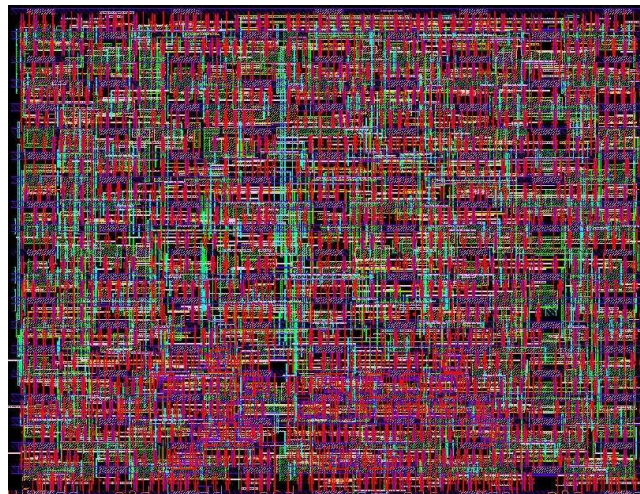
Figure II-6 : Vue de type masques (« layout ») d'un bloc digital placé routé (additionneur et multiplieur : 5000 transistors).
