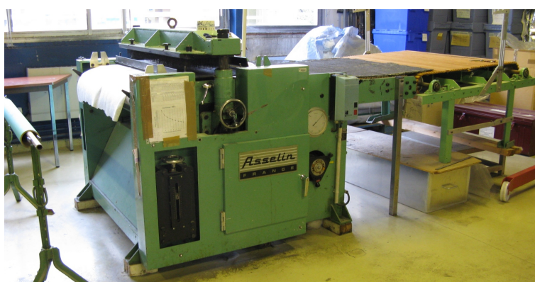
FIGURE II.5 – Machine à aiguilleter ASSELIN utilisée lors de la fabrication des supports de diffusion HEXCEL
