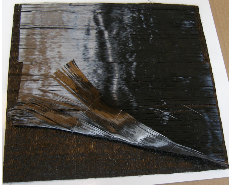
FIGURE II.9 – Exemple de mauvais aiguilletage
