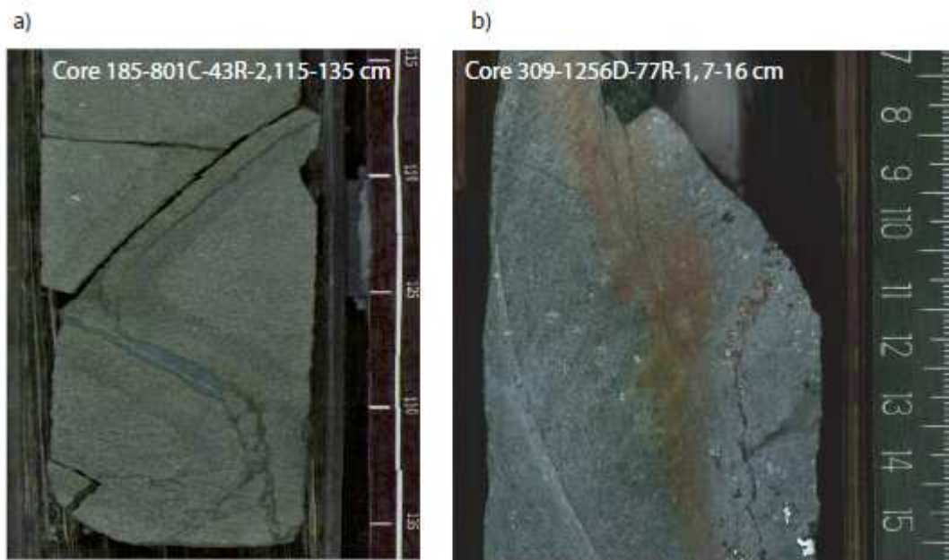
Figure 1-20 : Photographies de carottes de basaltes de sections de forage à travers la croûte océanique (Puits 801C et 1256D dans l'océan Pacifique).
