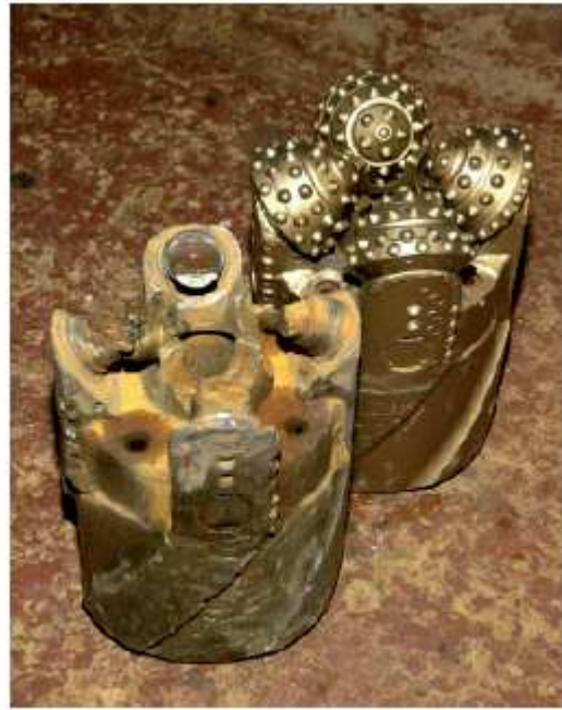
Figure 1-2 : Photographie montrant une tête neuve (en haut) et une autre totalement abîmée par le forage dans la croûte océanique.
