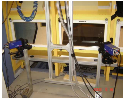
Fig. 2.25- Disposition des caméras par rapport à la soufflerie et au Mopet.
