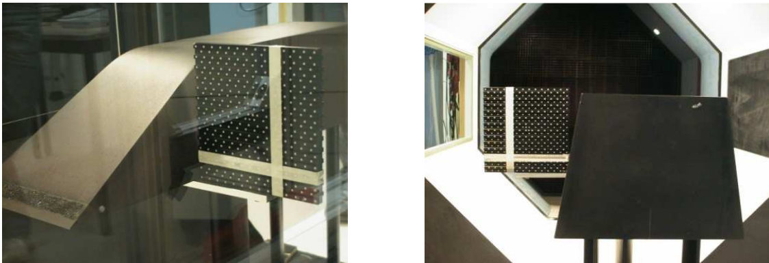
Fig. 2.26- Etalonnage des caméras pour un essai S-PIV, la mire est positionnée à 250mm du nez ( L2 ).
