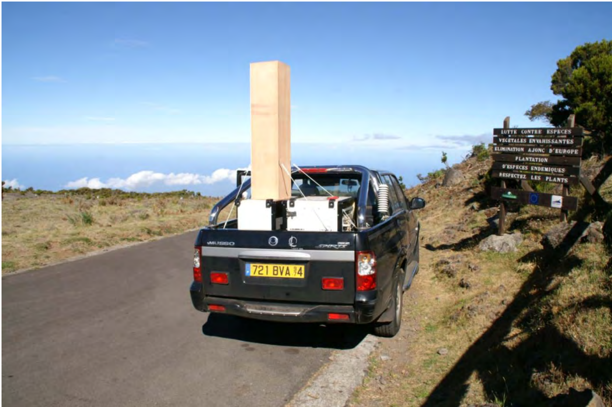
Figure 3-2: Lidar Aérosol Ultraviolet (LAUV) embarqué à bord d'un pick-up, déployé au cours de la campagne ECLAIR.
