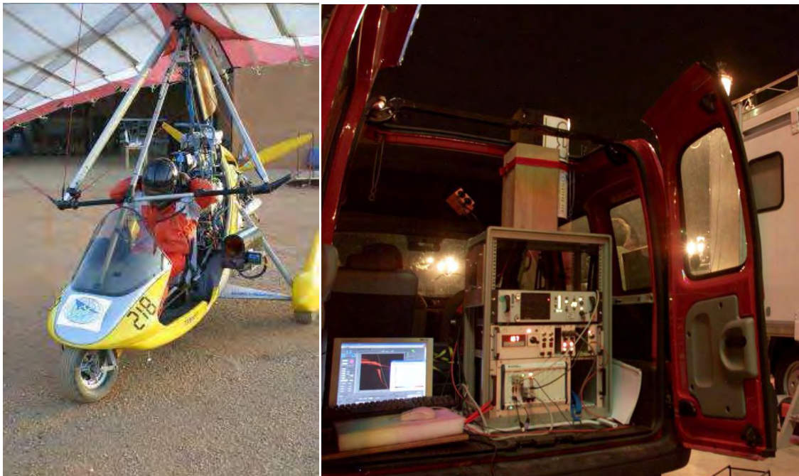
Figure 3-1: Lidar LAUV embarqué dans un ULM (à gauche) et dans un véhicule léger (à droite).
