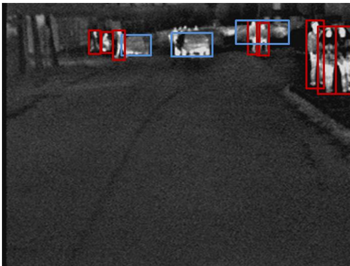
Figure 1.3. Exemple d'une scène routière en IR (bande LWIR) où les obstacles sont correctement détectés. Les piétons et les voitures sont respectivement encadrés par des rectangles (fenêtres englobantes) en rouge et en bleu.
