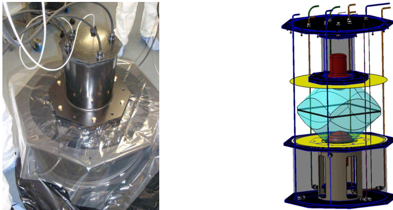
FIG. 9.33: Vue en coupe d'un module de \text{BiPo}_3 ; à gauche : photographie prise lors de l'installation au LSC; à droite : schéma mécanique
