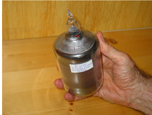
FIG. 7.2: Bouteille en quartz contenant une poudre enrichie en 82 Se et purifiée
