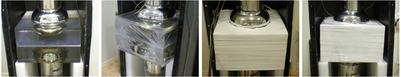
FIG. 9.31: Procédure d'isolement des scintillateurs pour la seconde série de mesures; de gauche à droite : scintillateurs nus, couches d'EVOH, couches de teflon, couches de film alimentaire
