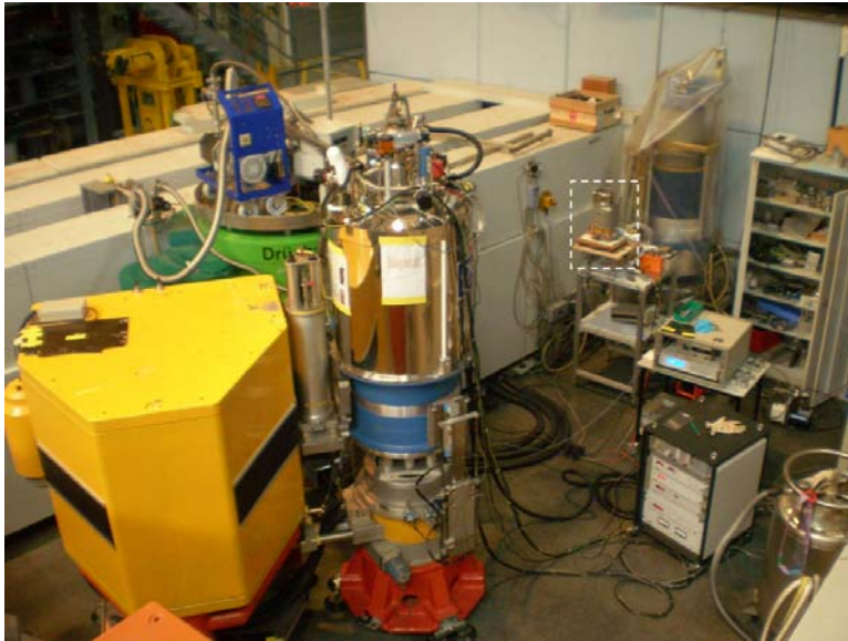
Figure 5.20 : Aire expérimentale RITA II : en premier plan, le spectromètre triaxial RITA II ; en arrière plan, le mur du blindage de la source SINQ d'où 4 lignes de faisceaux sortent. Le spectromètre bolométrique (zone en pointillés) est placé à proximité du guide de neutrons RITA II.
