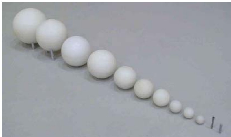
Figure 2.1 : De gauche à droite, un jeu de 10 sphères de polyéthylène de diamètre de 2 à 15 pouces, un capuchon en cadmium et le détecteur nu [Aroua, 1992a].
