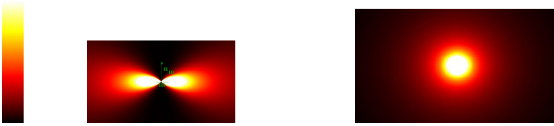
FIG. 8.6 – Probabilité d’un point p(s) pour le modèle stochastique avec un échantillonnage uniforme et un bruit sur l’orientation de la normale gaussien (à gauche), et uniforme (modèle boule à droite).
