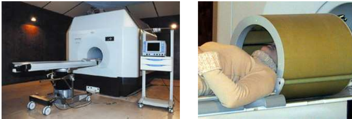
FIG. 2.12 – IRM Brucker 3 Tesla du centre IRMf du CHU de la Timone à Marseille et antenne tête (système radio-fréquence) de type "cage d'oiseau". Extrait de http://irmfmrs.free.fr/
