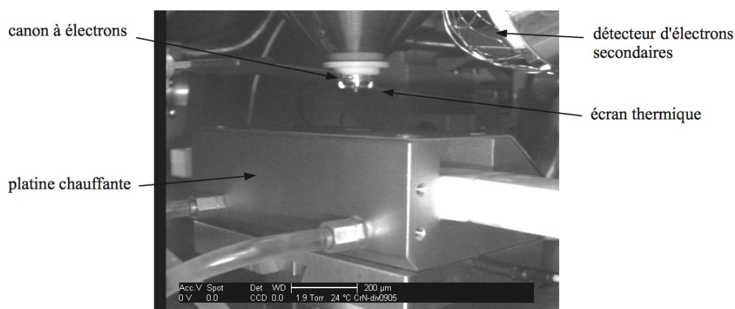
figure 14 : chambre de l'ESEM avec platine haute température.
