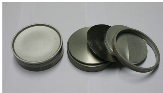
figure 12 : cible CAE-PVD classique (gauche) et montage développé par PLANSEE (droite).
