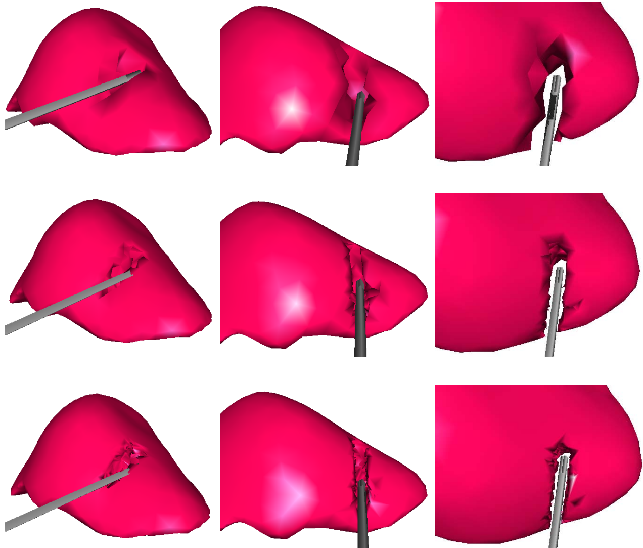
FIG. 4.14 – Exemple de découpe du foie. La première ligne montre la découpe sur le maillage de départ. Sur la deuxième et la troisième lignes la découpe est couplée avec l'algorithme de raffinement automatique de la zone en contact avec l'outil : chaque arête est subdivisée une fois pour la deuxième ligne et deux fois pour la troisième.
