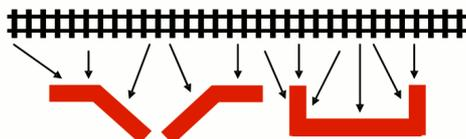
Figure 96 Plan masse, une orientation à éviter pour car elle augmente le linéaire de bâtiments exposés et favorise les réflexions. Source: rapport BahnVille 2, 2009<sup>626</sup>
