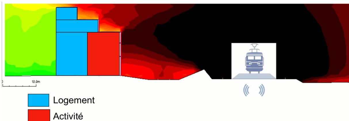
Figure 98 Le bâtiment "autoprotecteur". Source: rapport BahnVille 2, 2009<sup>628</sup>
