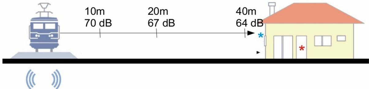
Figure 95 Plan masse, principe de l'éloignement. Source: rapport BahnVille 2, 2009<sup>625</sup>
