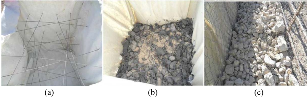
Figure 4-2 : Eléments constitutifs de l'ouvrage : (a) cellule de gabion avec géotextile et tirants, (b) mélange de sable et de déchetas de pneus, (c) remplissage de blocs calcaires concassés [REMPARE 2010].
