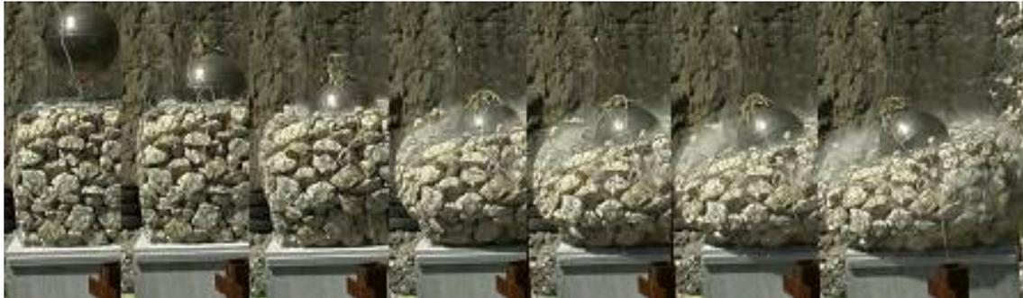
**Figure A 15 : Décomposition de l'essai d'impact sur une cellule de gabion « pierre » d'un mètre cube [Lambert 2007].**
