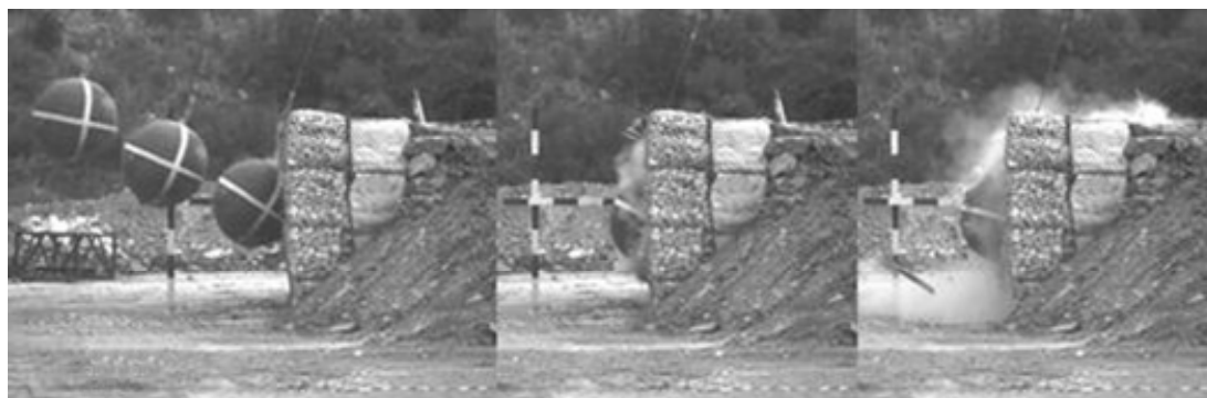
Figure 4-6 : Images prises à la caméra rapide pour un impact à 2000 kJ d'énergie [Heymann et al. 2010].
