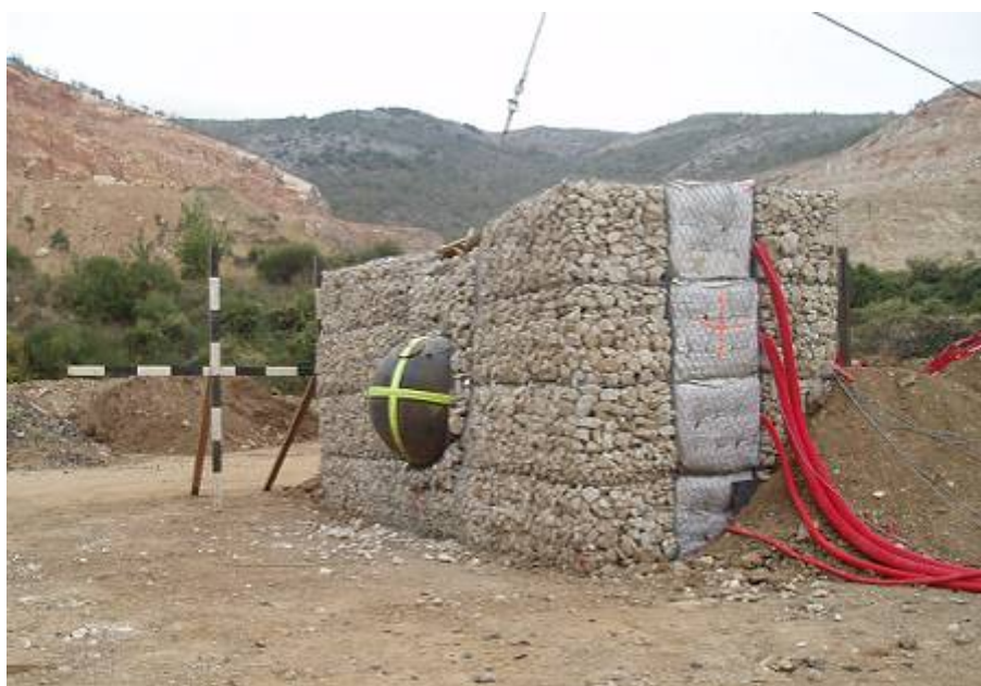
Figure 4-54 : Photographie, après impact, d'un merlon à technologie cellulaire, composé de gabions « pierre » aux parements amont et aval et de gabions « sable + déchet de pneus » dans le noyau.
