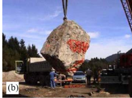
Figure 1-22 : Image du dispositif de lâcher de blocs rocheux en granite depuis une grue.
