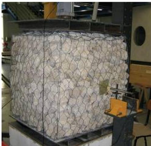
Figure 4-12 : Dispositif expérimental de compression simple sur cellule de 1 m<sup>3</sup> et système de mesure des déplacements latéraux [Lambert 2007].
