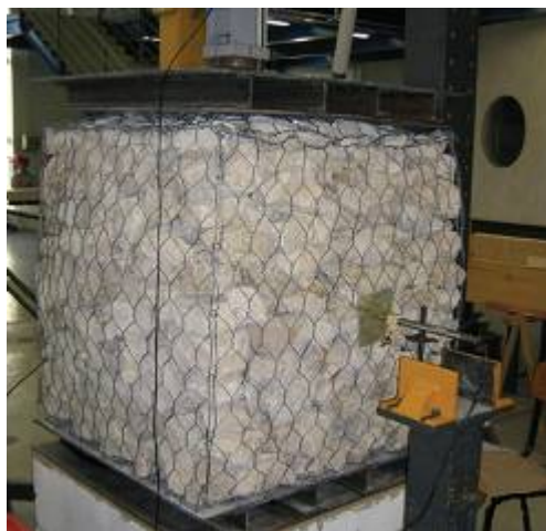
Figure 4-12 : Dispositif expérimental de compression simple sur cellule de 1 m 3 et système de mesure des déplacements latéraux [Lambert 2007].
