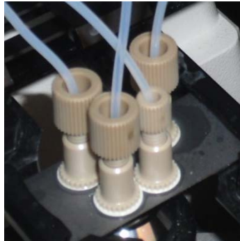
Figure II.7 : Tubes et connectiques Upchurch branchés sur une puce microfluidique pendant la manipulation
