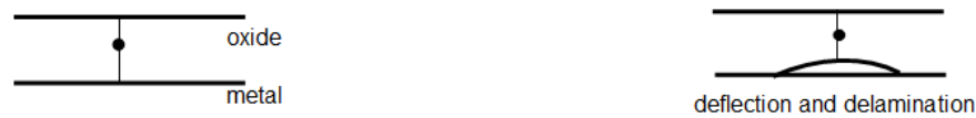
Figure II.2 : Mécanismes de rupture de la couche d'oxyde soumise à des contraintes de traction [89]
