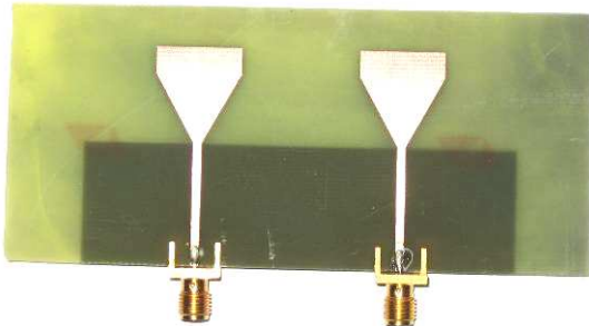
Photographie du système à deux monopoles avec d= 38\text{mm}
