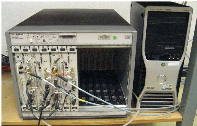
Figure 7-13. Vue du récepteur à deux voies reposant sur un châssis VXI
