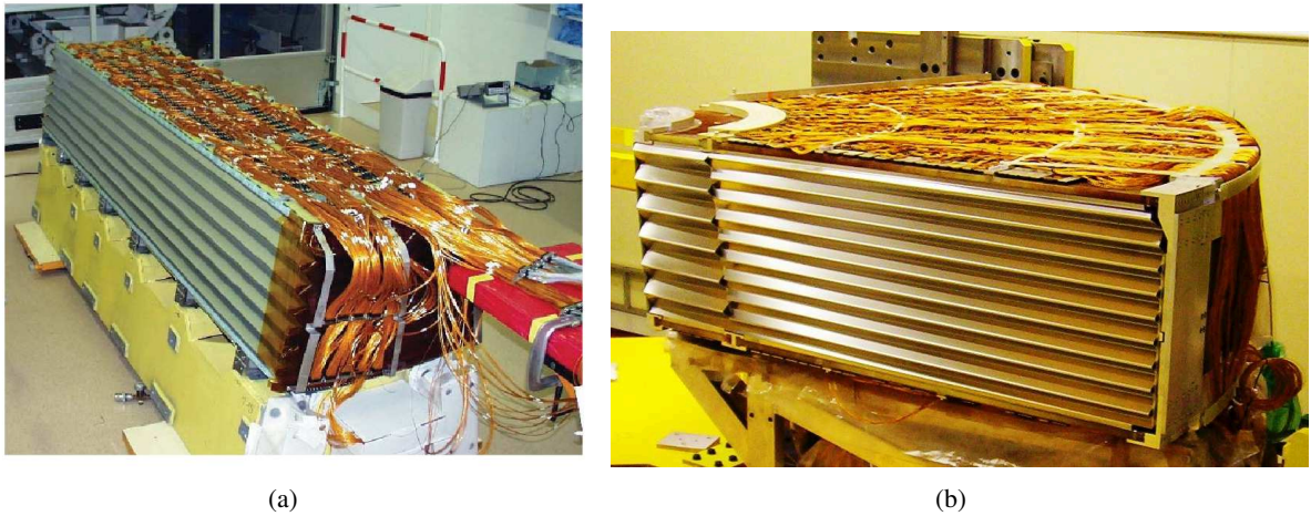
FIGURE III.19: Photographie d'un module du calorimètre électromagnétique, de la partie tonneau (a) et de la partie bouchon (b).
