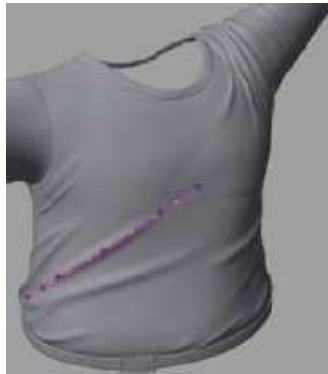
FIGURE 1.53 – Courbes de plis dessinés manuellement sur une surface. L'utilisateur peut paramétrer la localisation et le rayon d'influence de ces courbes au cours du temps. Image provenant de [CGW + 05].
