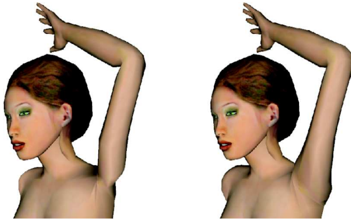
FIGURE 1.32 – Résultats obtenus après application d'une déformation par quaternions duaux (droite) par rapport à l'interpolation linéaire (gauche). Image issue de [KCZO07].
