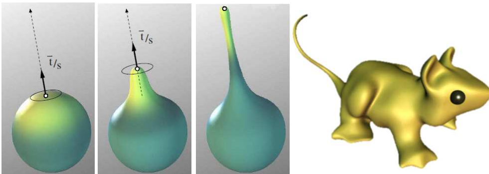
FIGURE 1.47 – Déformation à volume constant tirée de [ACWK04b]. Les images de gauches représentent l'outil de déformation préservant le volume. L'image de droite représente une réalisation formée à partir d'une sphère unique.
