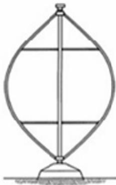
**Figure 1.24 : Schéma d'une turbine à forme troposkienne**
