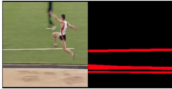
Figure 3.1 — Exemple de droites extraites par transformée de Hough ( \rho = 1 , \theta = \pi/180 et \Gamma = 100 ) sur un exemple de saut en longueur.
