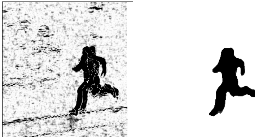
Figure 3.18 — Masque des pixels en mouvement (n'appartenant pas au mouvement dominant) avant et après filtrage morphologique, obtenu en utilisant Motion2D.
