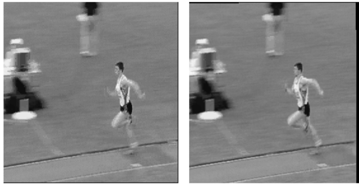
Figure 3.3 — Exemple de compensation de mouvement (modèle affine) effectuée en utilisant Motion2D sur un exemple de saut en longueur.
