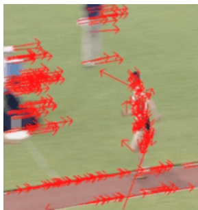
Figure 3.9 — Exemple de flot optique calculé par la méthode de Lucas-Kanade (qualité : 0.01 et distance : 0.01) sur les points d'intérêt - séquence de saut en longueur.
