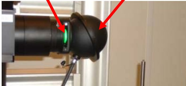
Figure 29. Système optique permettant la réalisation d'un plan de Fourier d'illumination.
