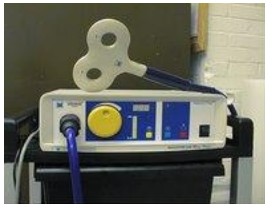
Figure 16 : Bobine de stimulation en forme de « 8 » et stimulateur.
