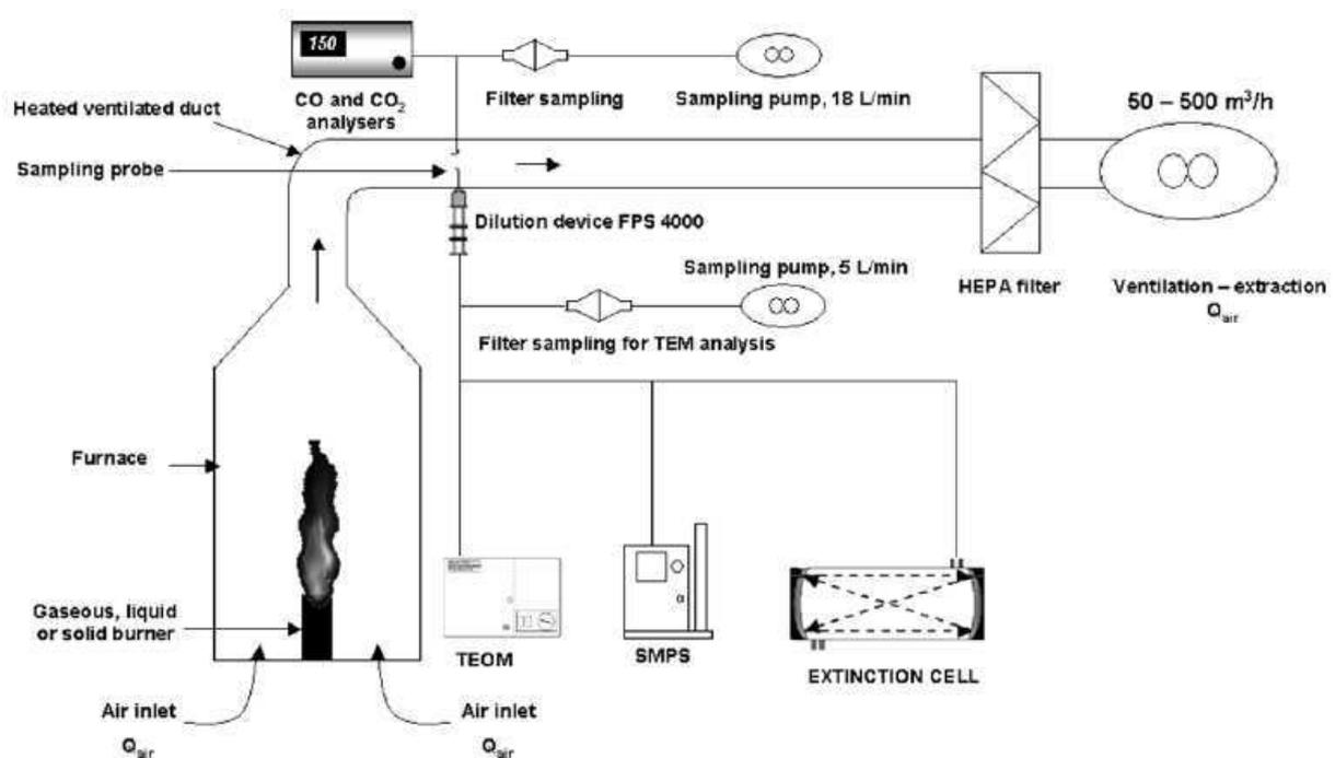
**Figure 61 : Schéma descriptif du dispositif expérimental effectué pour produire les suies**
