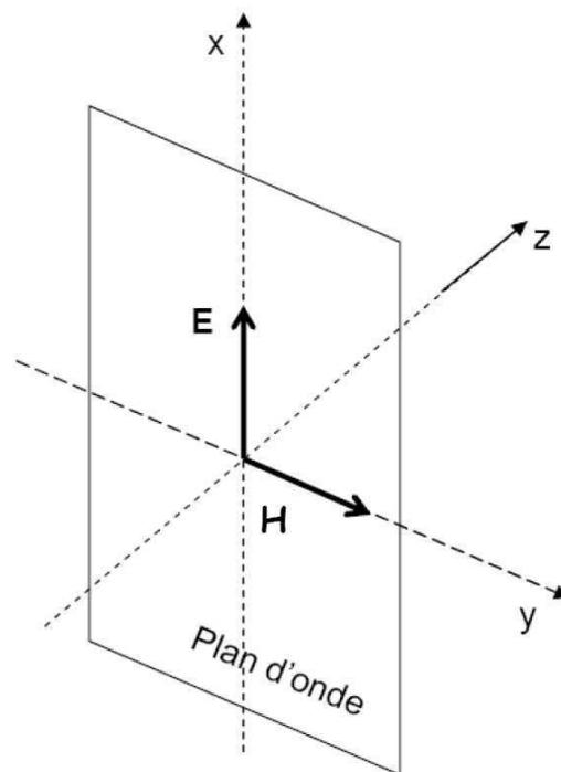
**Figure 8 : Représentation du champ électrique  $E$  et du champ magnétique  $H$  par rapport à la direction de propagation de l'onde ( $Oz$ )**
