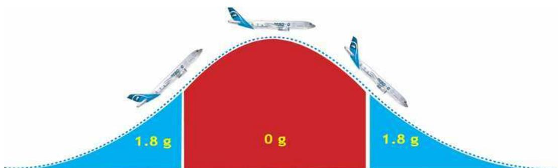
**Figure 31 : Technique du vol parabolique. Source : NOVESPACE**
