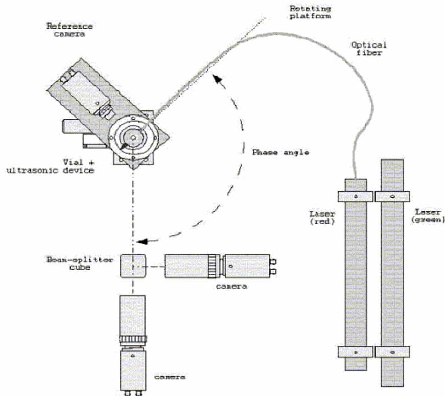
Figure 23 : Principe de mesure de PROGRA2-vis
