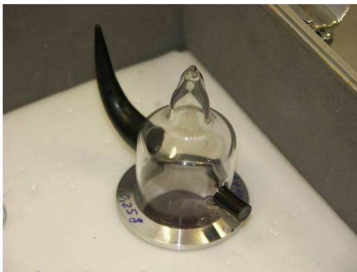
**Figure 33 : Photographie de la fiole et du bouchon utilisés en vols paraboliques**
