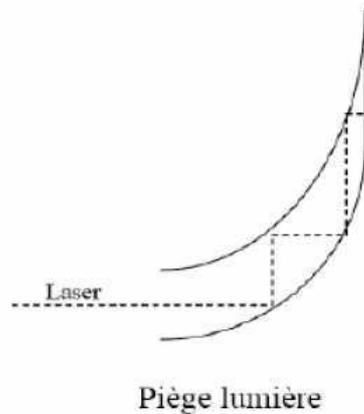
**Figure 28 : Principe de fonctionnement du piège lumière**
