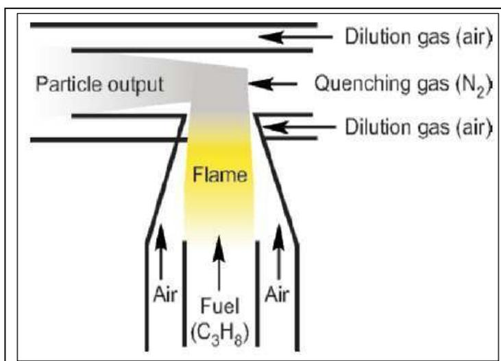
**Figure 55 : Système de combustion dans miniCAST. Extrait de Barthazy et al. (2006)**
