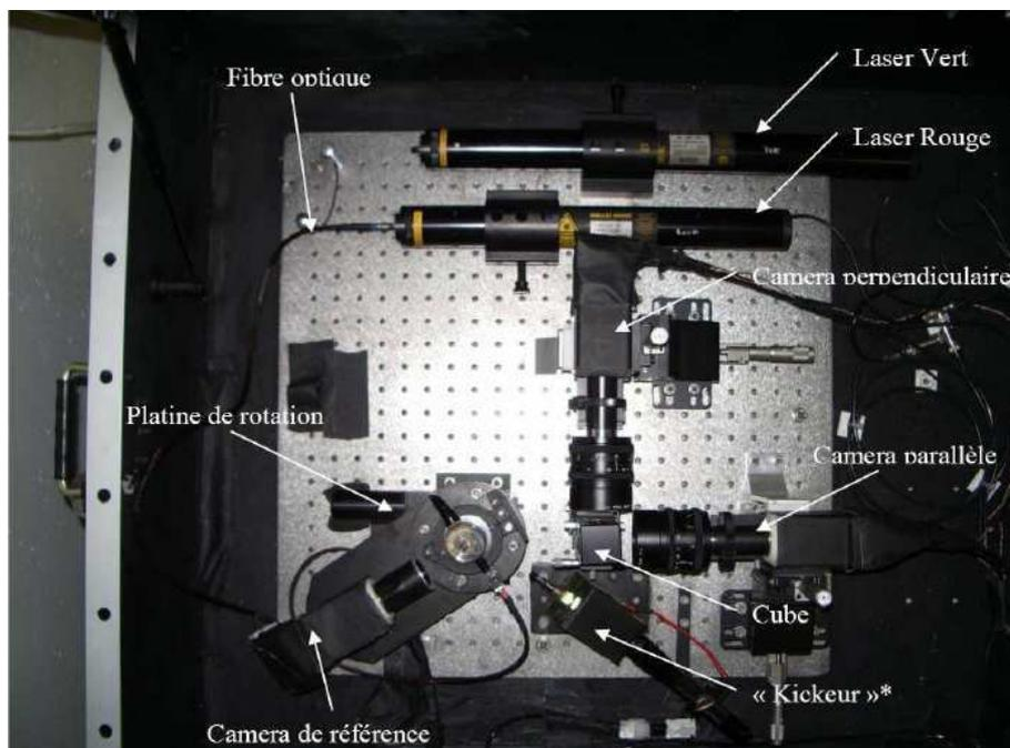
**Figure 22 : Photographie de la caisse optique de PROGRA2-vis**
