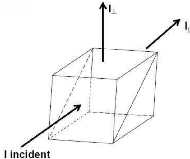
**Figure 34 : Cube optique qui sert à séparer les composantes parallèles et perpendiculaires de la lumière au plan de diffusion**
